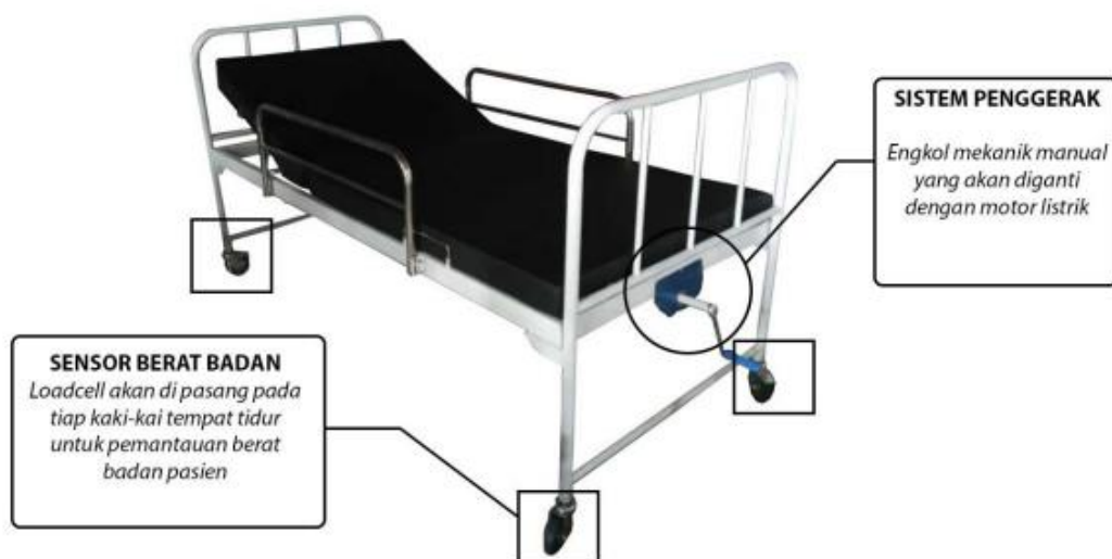
Gambar 1. Rencana pengembangan tempat tidur konvensional menjadi elektrik
